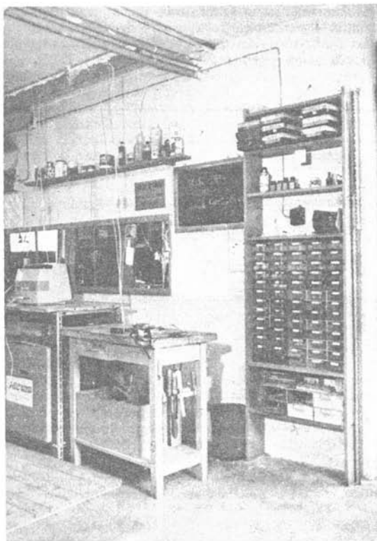
Fig. 1.4.1 - Scaffale magazzino minuterie, transistors, valvole. Sono anche visibili: l'assicella vernici, la lavagna approvvigionamento ricambi, il banco meccanico.
